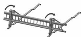
Bild 4. Låsklämman vikes över och slås ner med mjuk klubba i hålet där den låser. Se till att det låser ordentligt. (För att öppna används enklast mejsel.)
